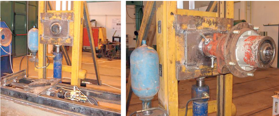
6. ábra A gumiabroncs-tartószerkezet [a szerzők]
