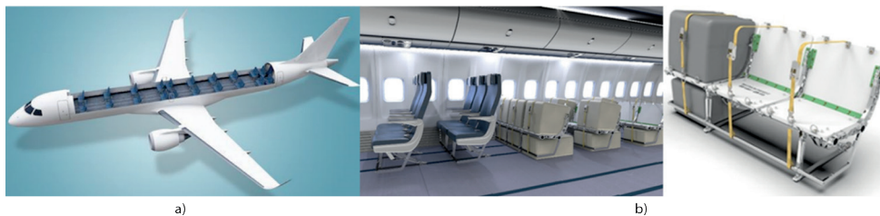
5. ábra Az utastér kombi kialakítása együttes utas- és teherszállításra [2], [10]
