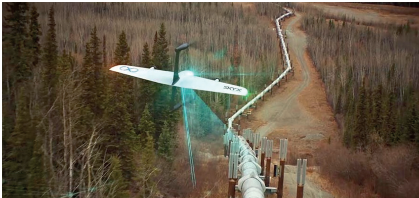
7. ábra Gázvezeték megfigyelése merevszárnyas drónnal [20]
