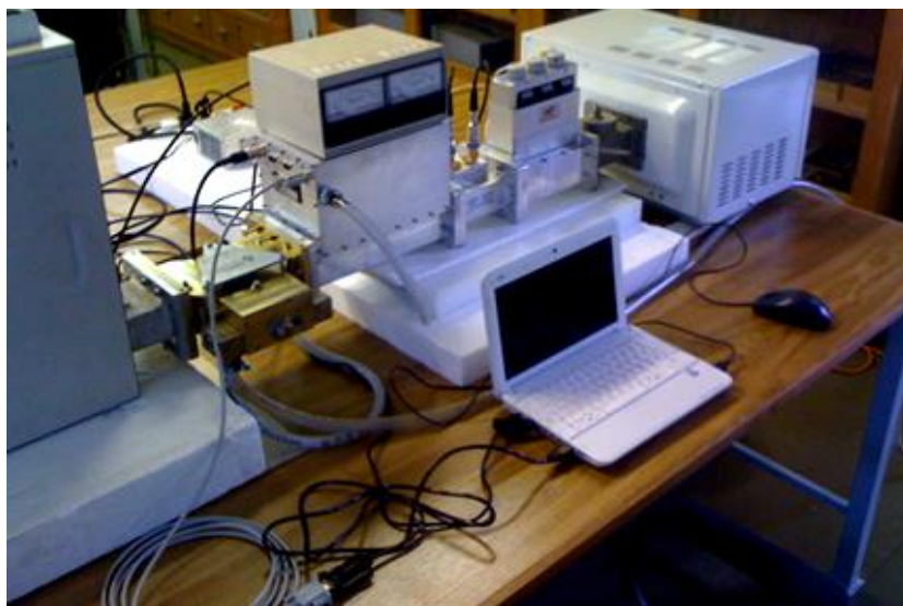
7. ábra Összeállítás az aktív szén dielektromos állandójának méréséhez
