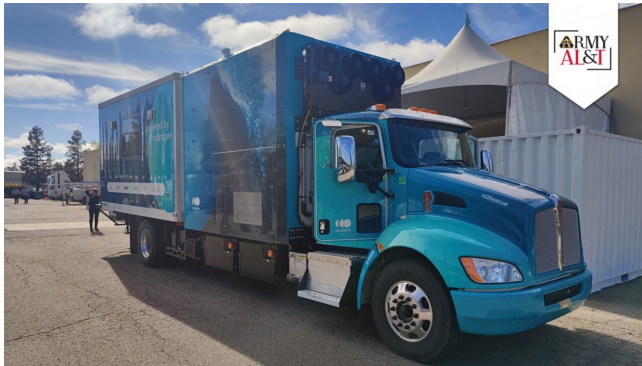
2. ábra Az Egyesült Államok hadseregének hidrogénhajtású kamionja [17]
