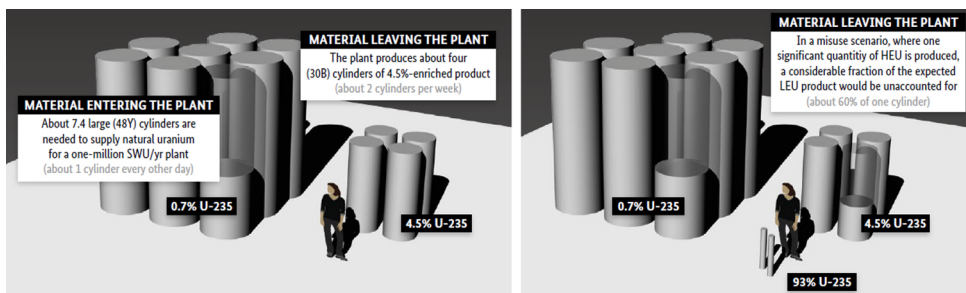
4. ábra: Dúsítóüzembe belépő és onnan távozó urán kéthetes időszak alatt Forrás: GLASER–NIEMEYER 2021: 101.
