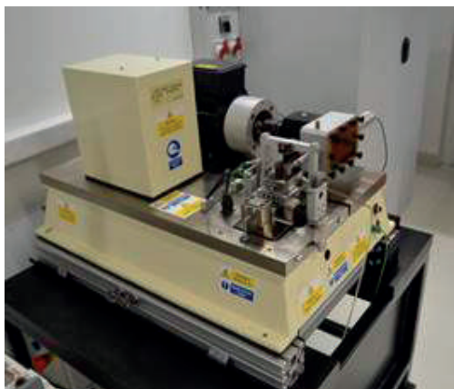
6. ábra. Plint TE-77 High Frequency Friction Machine és a vizsgálatokhoz használt próbatetek (Készítette: a szerző)
