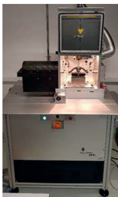
4. ábra. Optimol SRV5 Tribométer (készítette: a szerző) és a használt vizsgálati testek (1. megmunkált próbatest-felület, 2. relatív elmozdulás) [4]
