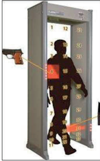
1. ábra. Garrett PD6500i fémérzékelő kapu működése [18]
