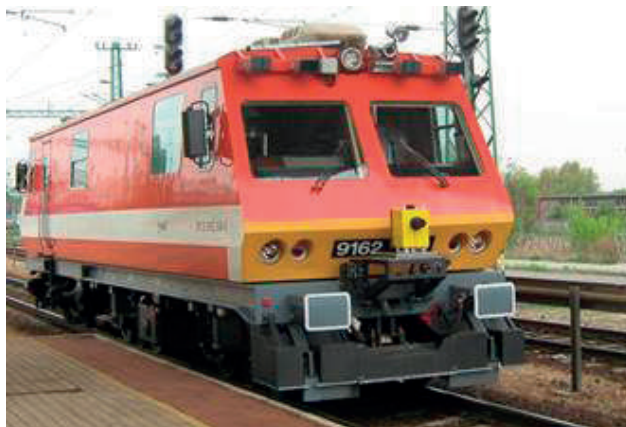
5. kép. MÁV Központi Felépítményvizsgáló Kft. FMK-004 jelű vágánygeometriai mérőkocsija űrszelvényt mérő forgólézerrel és videorendszerrel (Forrás: MÁV KfV Kft.)
