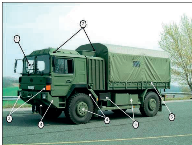
2. ábra. Jellegzetes rejtési helyek, fontosabb ellenőrzési pontok tehergépjárművön
