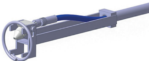
8. ábra: Áttervezett távtartó fúvókatartóval
