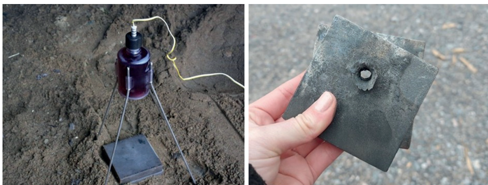
5. ábra: J-Etna™ alkalmazása acéllemezen
