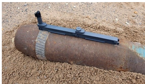
2. ábra: Dioplex EOD TM vágótöltet alkalmazása a gyakorlatban
