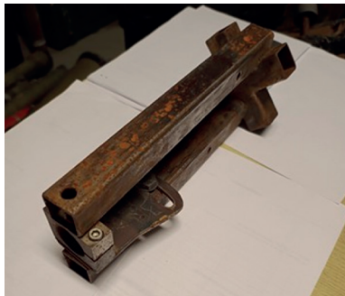
3. ábra: Zártszelvényből készített befogó és távtartó
