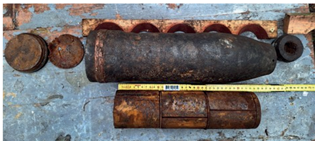
7. ábra: Orosz 122 mm-es A-462 propagandagránát szétszerelés után
