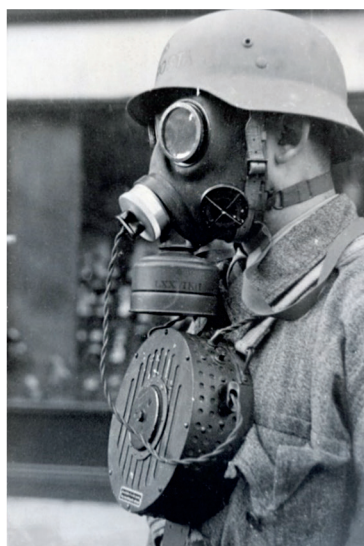
13–14. képek: A CO-szűrőbetét szerkezeti felépítése és a 33M tűzoltó álarc mikrofonnal és hangosbeszélővel integrált változata, a magyar királyi posta egyik légoltalmi beosztottján
