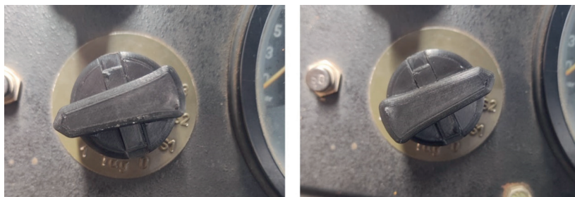
11. ábra: A világításfőkapcsoló beszerelt fogantyúval és a kapcsoló végállása
