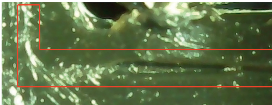
8. ábra: A két külön alkatrész összeolvadt felületei
