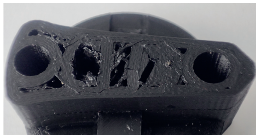
9. ábra: A nyomtatás során összeolvadt alkatrészek
