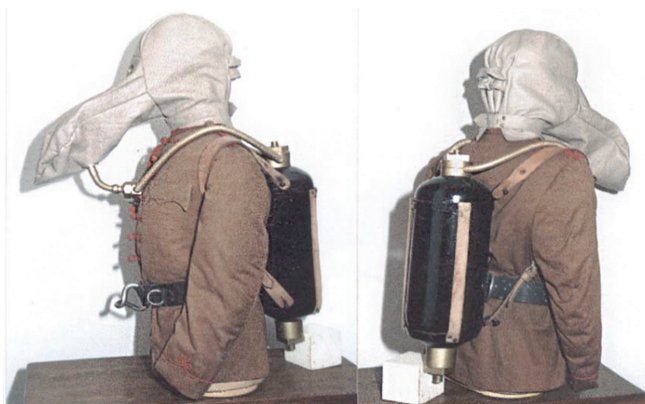
1. ábra: A Kőszeghi-féle „életmentő készülék” hordhelyzetben
