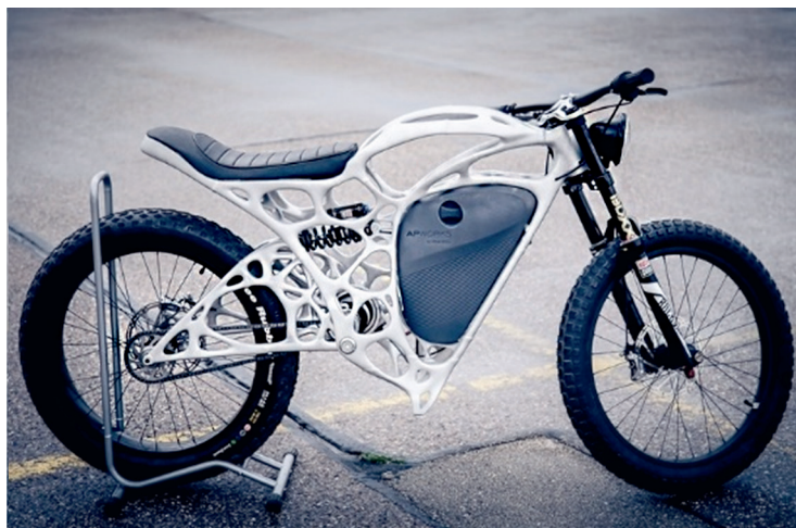
4. kép: Az Airbus APWorks elektromos motorkerékpár topológiaoportimalizált 3D-s nyomtatott fémváza, amely mindössze 6 kg tömegű
