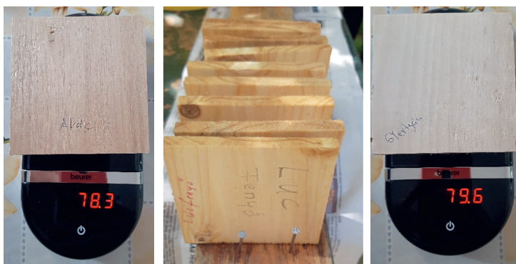
1. kép: Minták és tömegmérés a vegyszeres kezelés előtt
