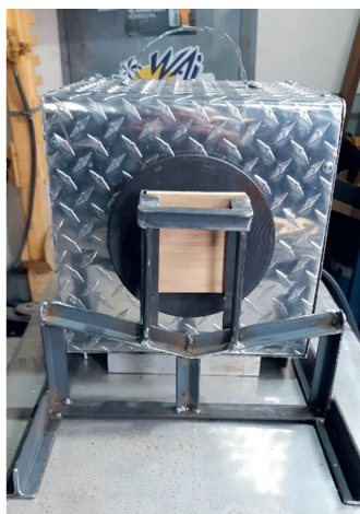
2. kép: Az egyedi tervezésű berendezésben elhelyezett fa mintaanyag helyzete a vasmag előtt
