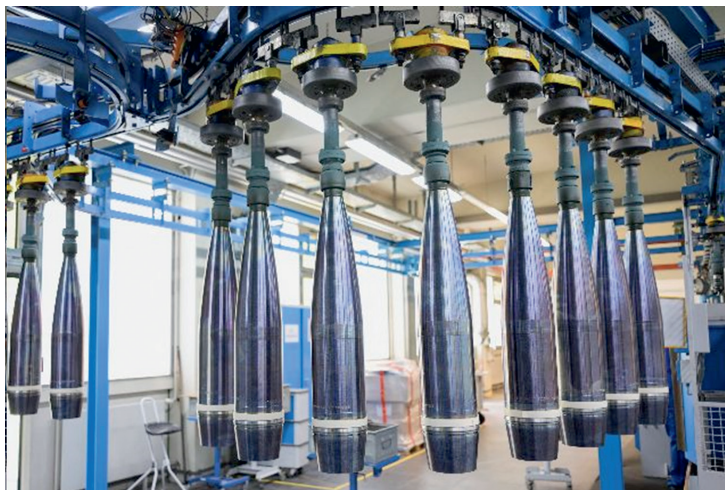
1. ábra: 155 mm-es tüzszerégi lőszer gyártósora a Rheinmetall üzem létesítményében
