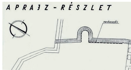
7. ábra. Régi vészkijáratí folyosókialakítás a budai várban a volt Állami Nyomda életvédelmi létesítményénél (ma már helytelenül egyenesre át van építve)
