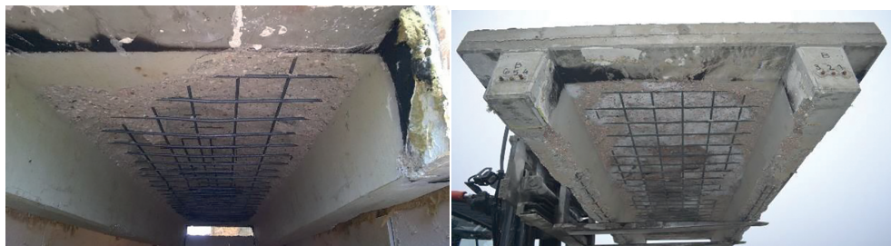
a) az etalon TT-panel a vizsgálat után
