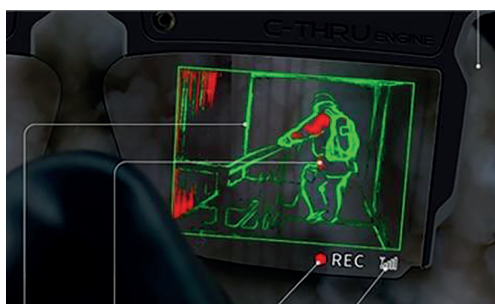
1. ábra. Qwake Tech futurisztikus, AR-tartalommal ellátott sisakja és a tűzoltó által látott kép füstben, rossz látási viszonyok között
