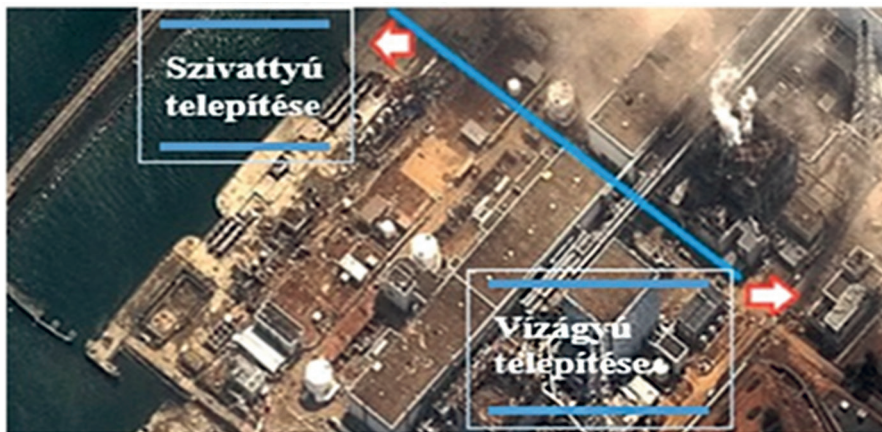
8. ábra: Kijelölt telepítési és vízszervezési helyek
