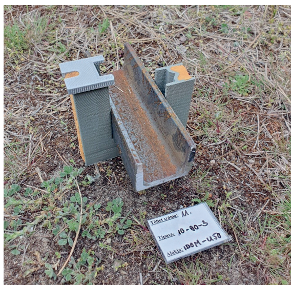
4. ábra: Egy 90°-os kumulatív idomtöltet 50 mm-es U szelvény céltárggyal Forrás: a szerző felvétele
