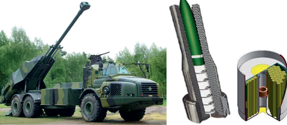
1. ábra: BAE 155 mm/L52 Archer tarack és a GUDN hajtóanyag elrendezése (az UNIFLEX 2 IM moduláris tüzérségi töltetben)
