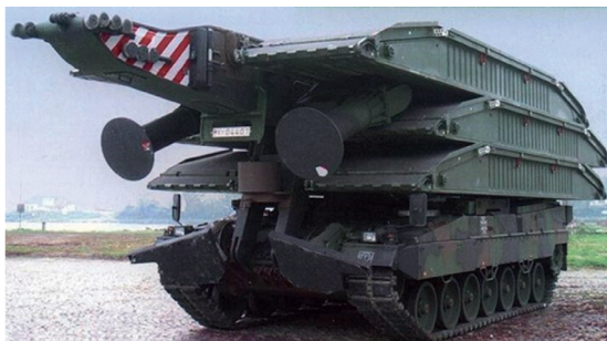
2. ábra: Panzerschnellbrücke 2 hídvető harckocsi
