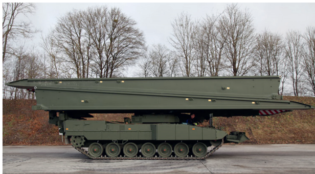
3. ábra: Leopard 2 Leguan hídvető harckocsi 26 m-es híddal
