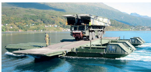
8. ábra: Leguan híd alkalmazása áthajózási kompon
