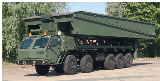
7. ábra: Leguan hídrendszer tehergépjárművön
