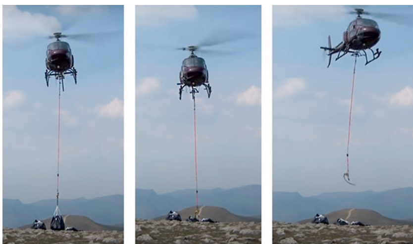
28. ábra: Helibag zsák lerakása: (1) a zsák talajt ér, (2) a zsák kötele meglazul, (3) a kötél végén levő ledobó szerelvény a zsákot elengedte
