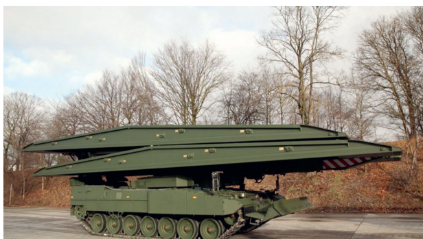
4. ábra: Leopard 2 Leguan hídvető harckocsi 2 db-os hídkészlettel
