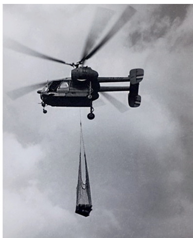
13. ábra: Robbanóanyagok szállítása Ka-26 típusú helikopterrel
