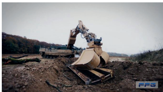
18. ábra: Speciális szétrnyitható kotrókanál alkalmazása egy tárgy megfogására Forrás: FFG (2020): i. m.
