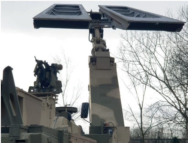
24. ábra: A nyompályás hídelem felemelése szállítási helyzetből
