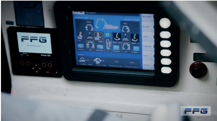
19. ábra: A hidraulikarendszer érintőképernyős kezelőpanelja Forrás: FFG (2020): i. m.
