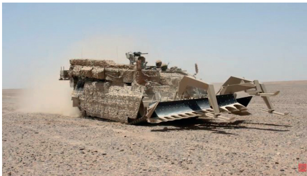
20. ábra: WiSENT 2 elől aknakifordító munkaszervvel, hátul sávjelölővel felszerelve Forrás: SNAFU blog (é. n.): i. m.
