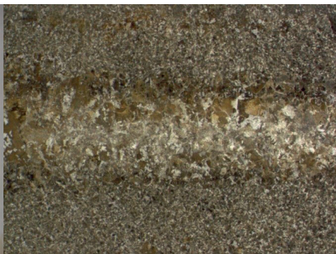
9. ábra. A varrat és a hőhatásövezet sztereomikroszkópos felvétele
