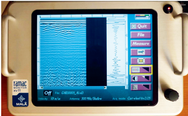
5. ábra. A talajradar monitorján megjelenő kép
