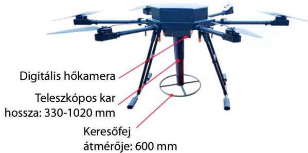
7. ábra. Fémkeresővel felszerelt hexakopter
