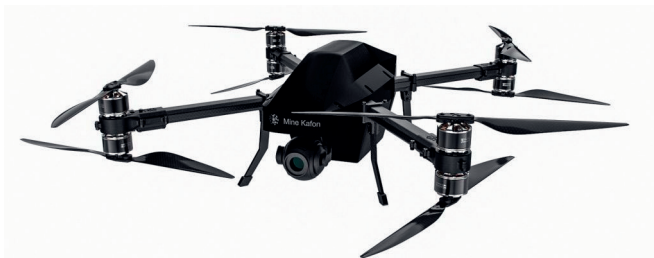
8. ábra. Dupla rotoros quadrokoopter optikai kamerával
