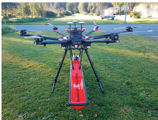
9. ábra. Talajradarral felszerelt hexakoopter
