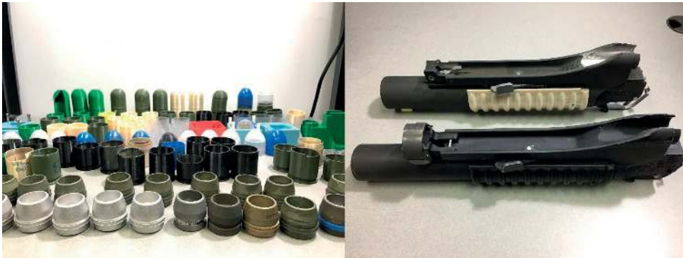
3. ábra. 3D-nyomatott lőszer (bal) és egy 3D-nyomatott és az eredeti alkatrész összehasonlító képe látható
