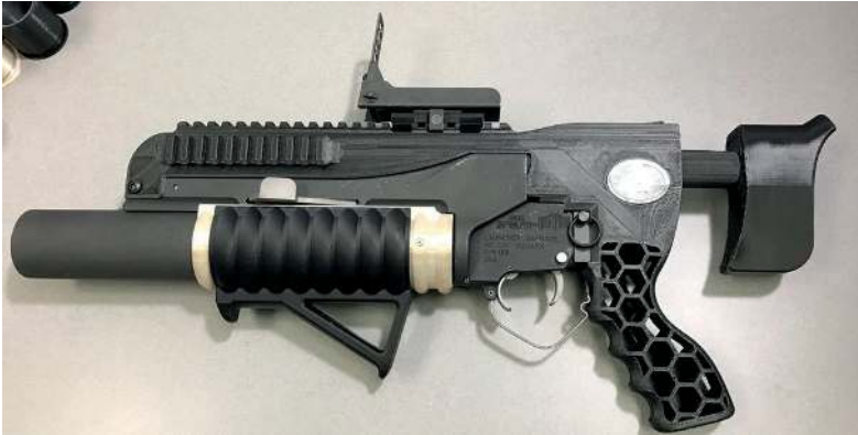
2. ábra. Az első ARDEC által készített 3D-nyomatott gránátvető, amelyből 3D-nyomatott lőszeret sütöttek el
