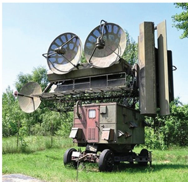
10. ábra: A „Fan Song E” NATO-kódú, G-sávú tűzvezető radarállomás a lengyel Haditechnikai Múzeumban (Muzeum Polskiej Techniki Wojskowej w Warszawie)
