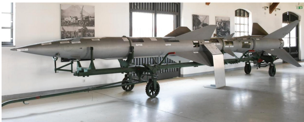
13. ábra: V-750V közepes hatótávolságú légvédelmi rakéta TSzSzT szállító targoncán a szolnoki RepTárban Forrás: a szerző felvétele
