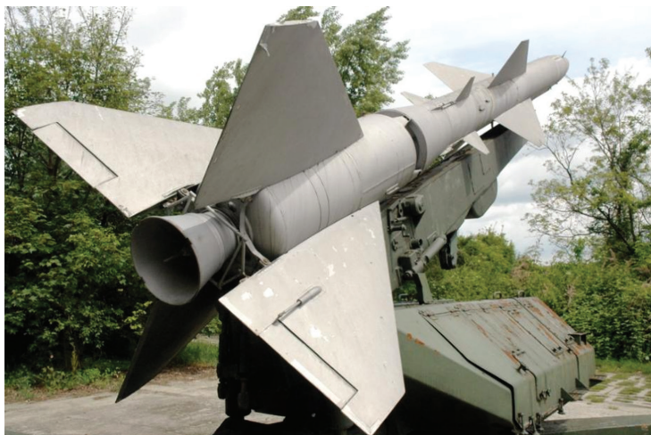
12. ábra: Az Sz–75 légvédelmi rakétarendszer V-755 típusú rakétája és indítóállványa
