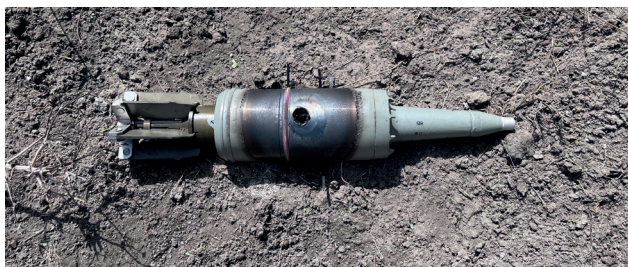
8. ábra: szovjet BK-14M kumulatív gránát tökéletes deflagrációja utáni állapot
