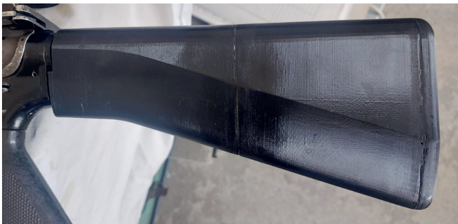
2. ábra: Kétkomponensű ragasztóval egyesített három darabban nyomtatott fegyvertusa Forrás: a szerző felvétele
