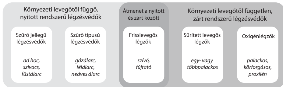
7. ábra: A légzésvédelmi eszközök csoportosítása működési elvük szerint
