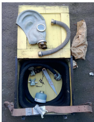
10. ábra: A magyar Medicor Művek által üzemeltetett polgári védelem számára gyártott szívó típusú friss levegős lézőkészlet az 1980-as évekből
