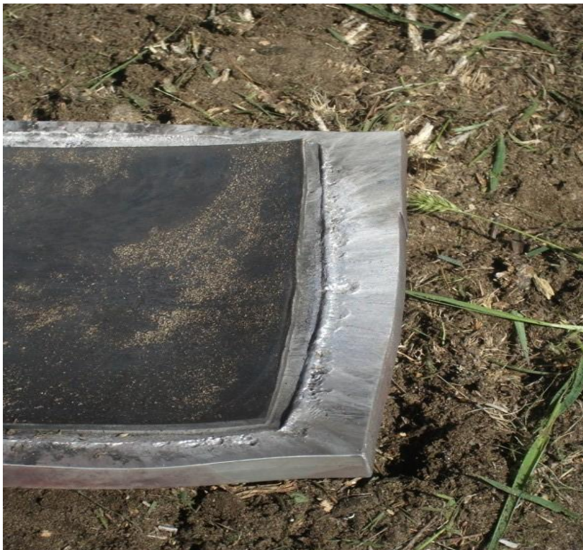
8. ábra: Az alaplemezen látható a kifröccsent olvadék 3
