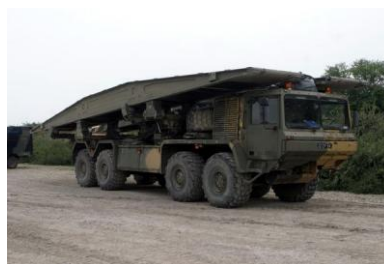
4. sz. kép Tank Bridge Transporter (TBT) 11. sz. híd 15
