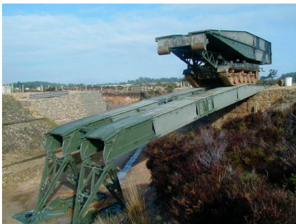
14. sz. kép Bakláb alátámasztás 28
