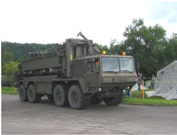
7. sz. kép GSB – Automated Bridge Launching Equipment (ABLE) 20
