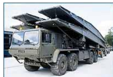
5. sz. kép Tank Bridge Transporter (TBT) 12. sz. híd 16
