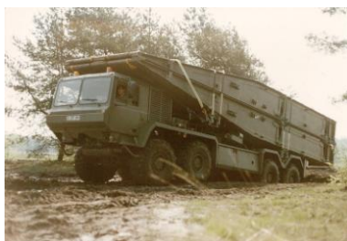
3. sz. kép Tank Bridge Transporter (TBT) 10. sz. híd 14
