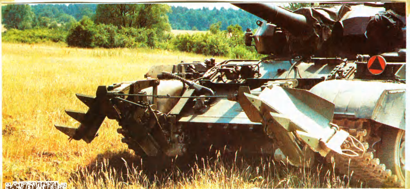
8.számú ábra: TW-92 aknakifordító eke
