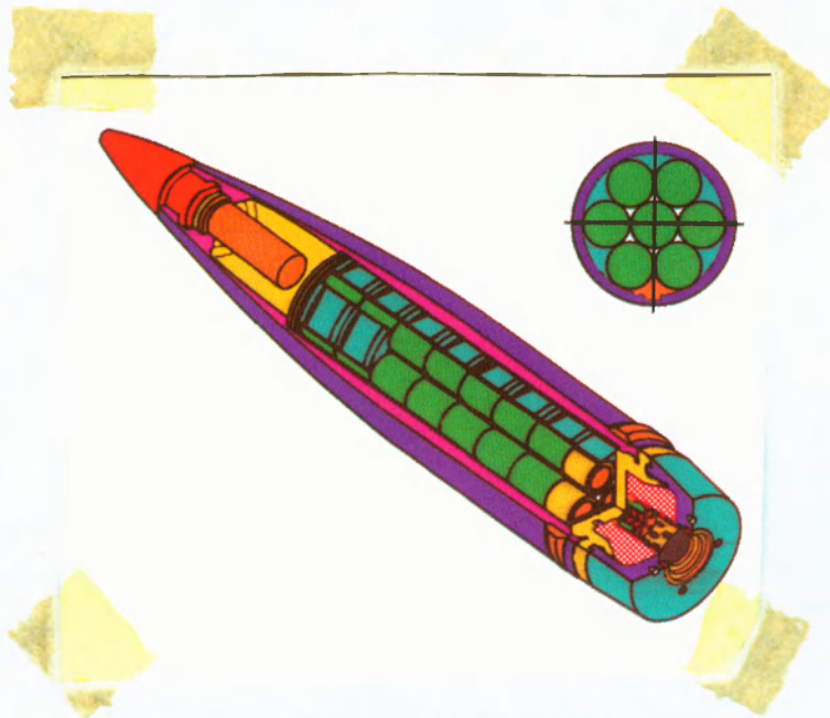
41.számú ábra: ER DP-ICM M350 152 mm-es kazettás tűzéri löszér metszeti rajza
