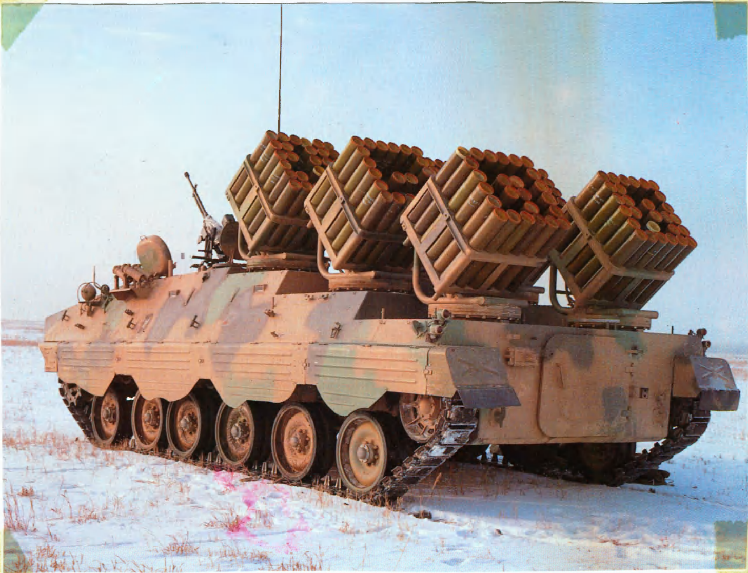
35.számú ábra: Műszaki aknaszóró WZ534 lánctalpas alapgépen
