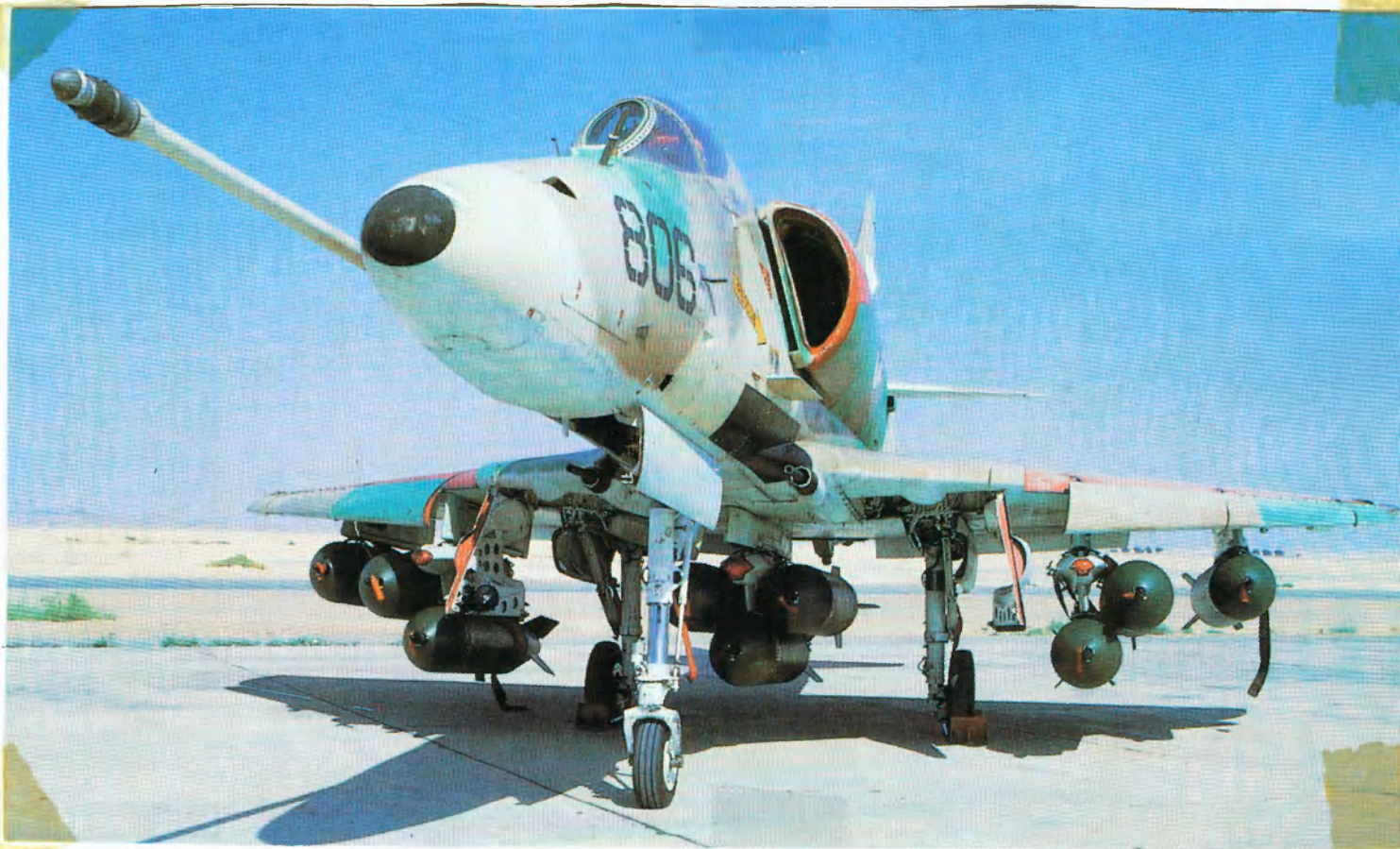
42.számú ábra: ATAP 500 aknakonténerek Skyhawk csatarepülőn
