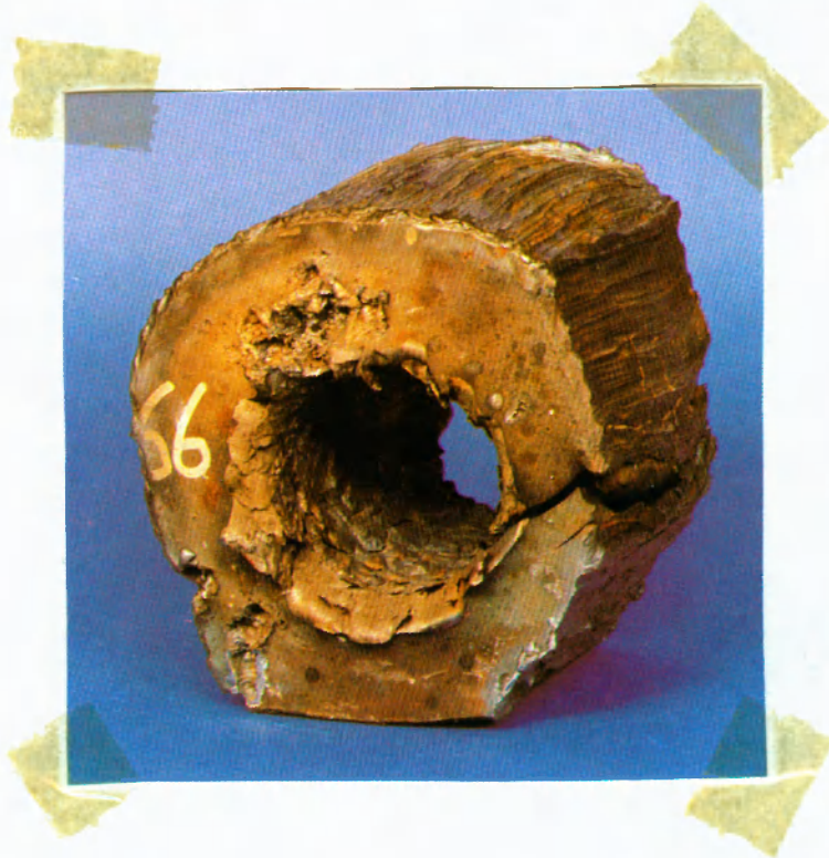
32.számú ábra: A BONUS lőszer harci részének hatékonysága
