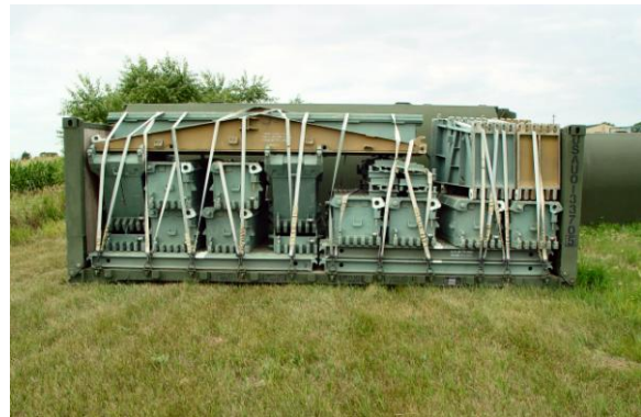
23. sz. kép Hídelemek az M1 „flatrack”-en 34
