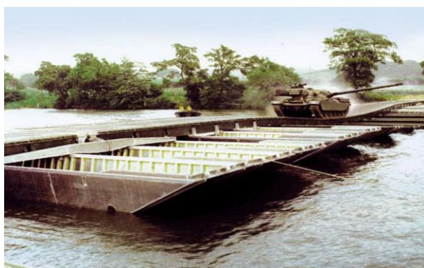
8. sz. kép Szimplatartós úszóhíd 18
