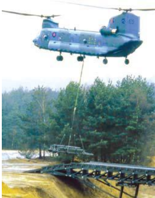
26. sz. kép Az MGB elemek helikopteres szállítása 41
