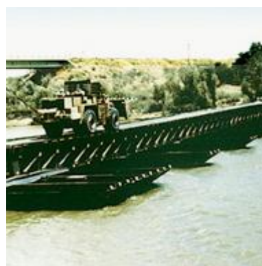
9. sz. kép Kettőstartós úszóhíd 19
