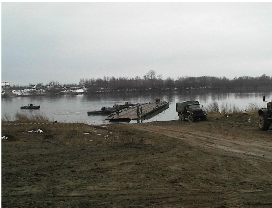
3. ábra: 120 tonnás PMP kompátkelőhely a Száván
