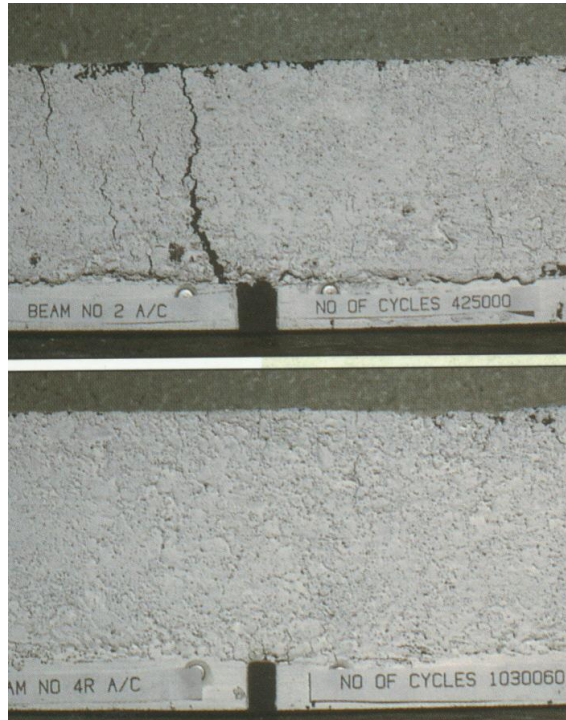
13. ábra: Aszfaltrétegek georács nélkül és georács erősítéssel
