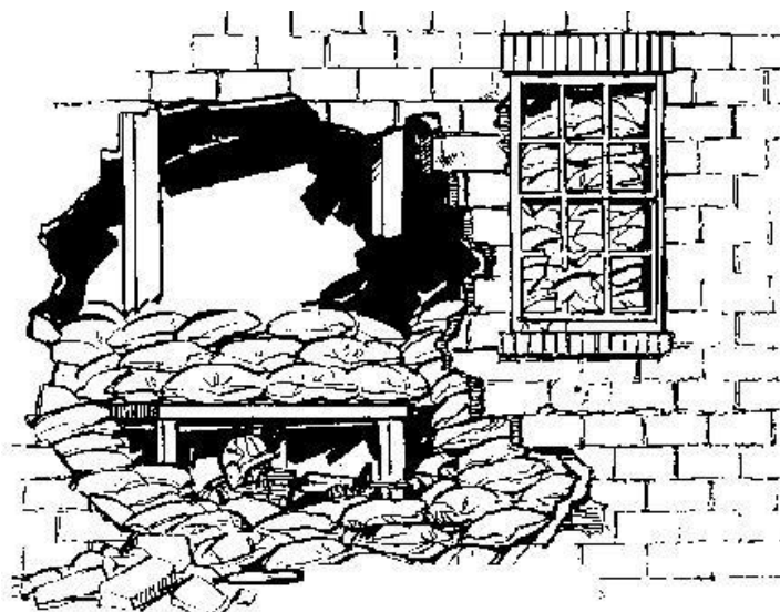
12. ábra: Egyéni tüzelőállás homokzsákokkal megerősítve
