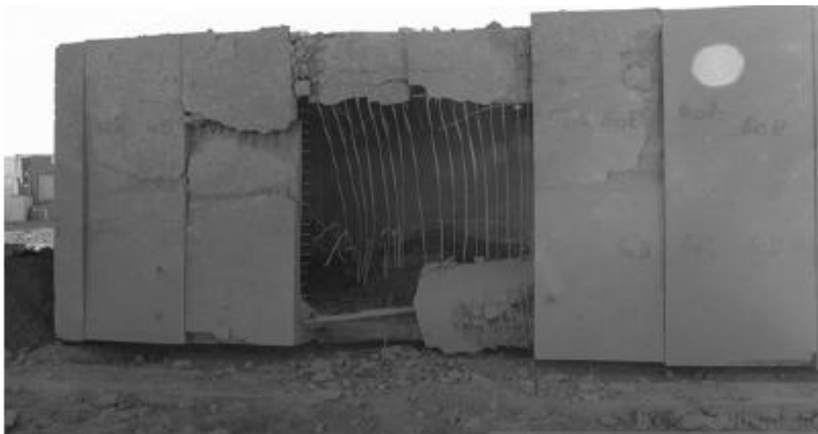
1. ábra: 6000 kg TNT egyenértékű robbanóanyag okozta repedés
