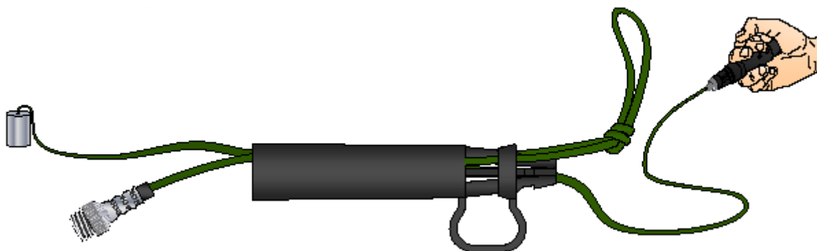
10. sz. ábra. Csatlakoztatás duplán átvezetett jelvezetékkel
