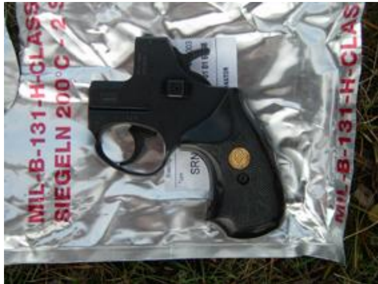
7. sz. ábra. MR–1 kézi elsütő mechanizmus (AUSTIN)
