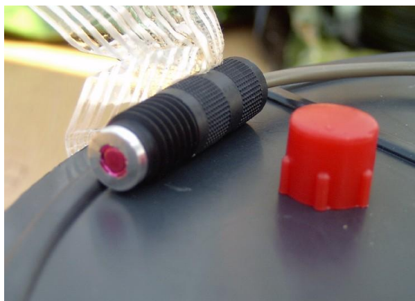
11. sz. ábra. Primer gyújtóegység (AUSTIN)
