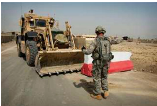
2. kép. Ellenőrző pont kiépítéséhez beton terelőt helyeznek el páncélozott buldózer segítségével 3
