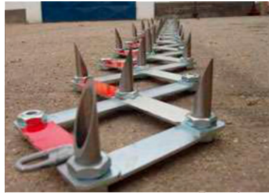
3. - 4. kép. Tüskés útzár telepítése
