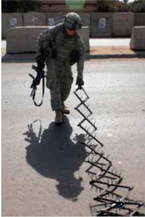
3. - 4. kép. Tüskés útzár telepítése
