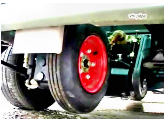
7. sz. kép A mérőkerék „hordhelyzetben” [9]
