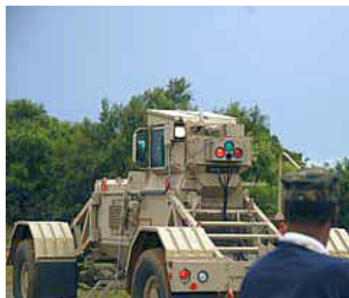
12. ábra A rendszer hátsó jelzőfényei 30
