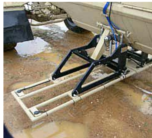
10. ábra Az érzékelő panel munkahelyzetben 28
