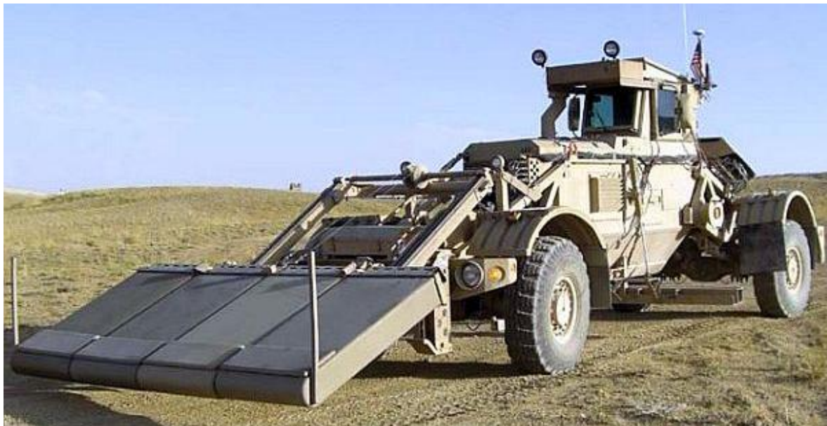
13. ábra Huskyra szerelt talajradar 33
