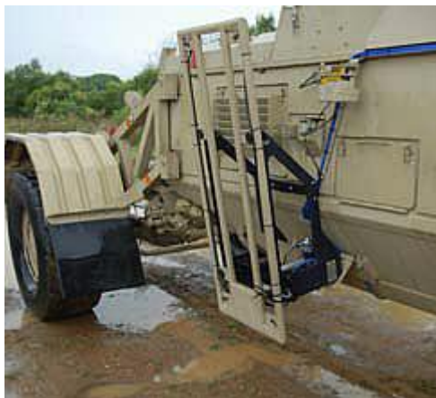
9. ábra Az érzékelő panel menethelyzetben 27
