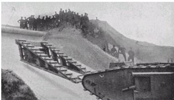
Harckocsi fal leküzdése rámpával 54
