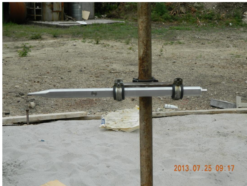
1. sz. ábra: PCB Piezoelectronics 137A21 típusú külső nyomásmérő szonda 9
