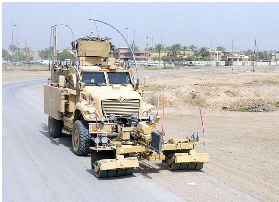
11. ábra Rhino III és SPARK közösen alkalmazva 20
