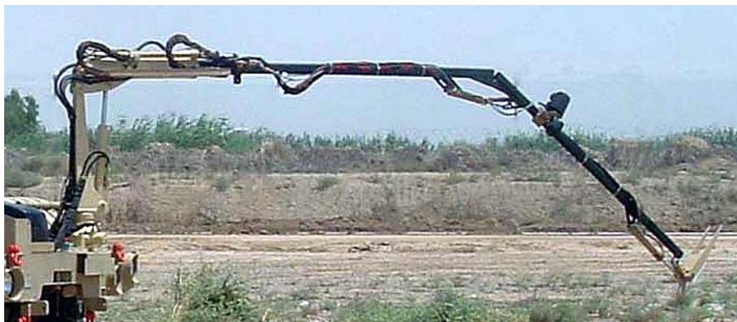
6. ábra Gémszerkezet a kamerával és a fogóvillával 13
