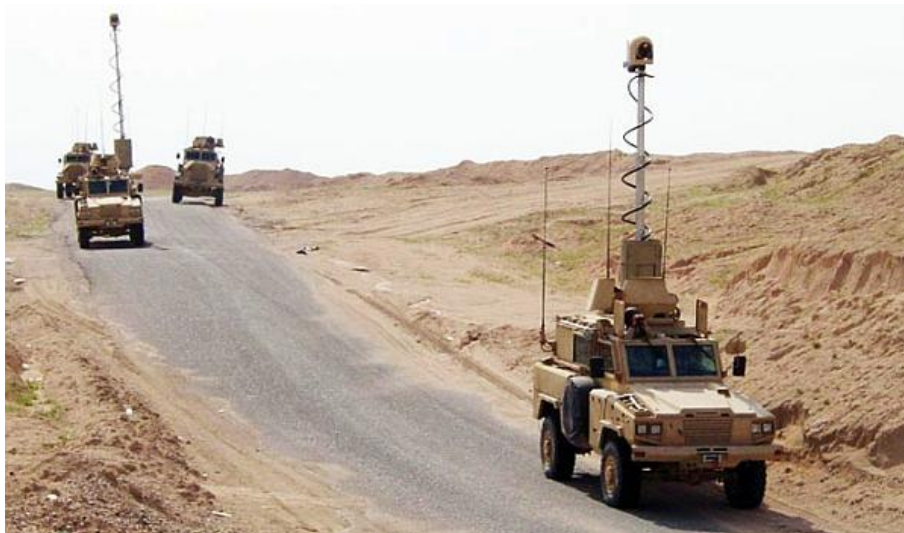
12. ábra Gépjármű optikai érzékelő rendszer munka közben 22
