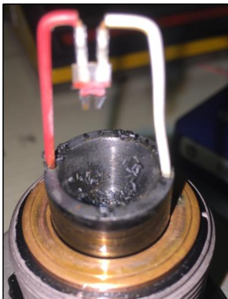
A lőpor tökéletlen égése következtében visszamaradt szemcsék
