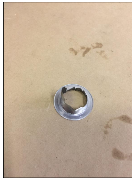
A gersli betöltve vizsgálat előtt, a szakadó membrán felnyílvá
