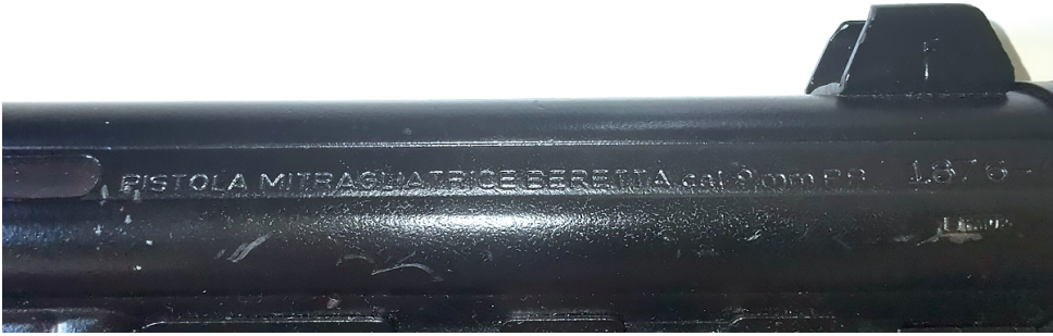
9. ábra: 9 × 19 mm-es Beretta M12 géppisztolyon található gyári jelzések „PISTOLA MITRAGLIATRICE BERETTA cal. 9 mm PB” és fegyverszám
