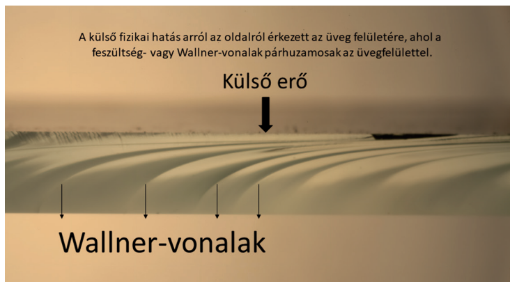
3. ábra: Wallner-vonalak mikroszkópos képe
