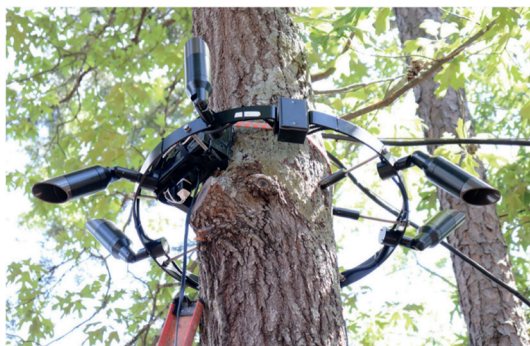
10. ábra: Akusztikus és rádiófrekvenciás szenzorok együttes alkalmazása
