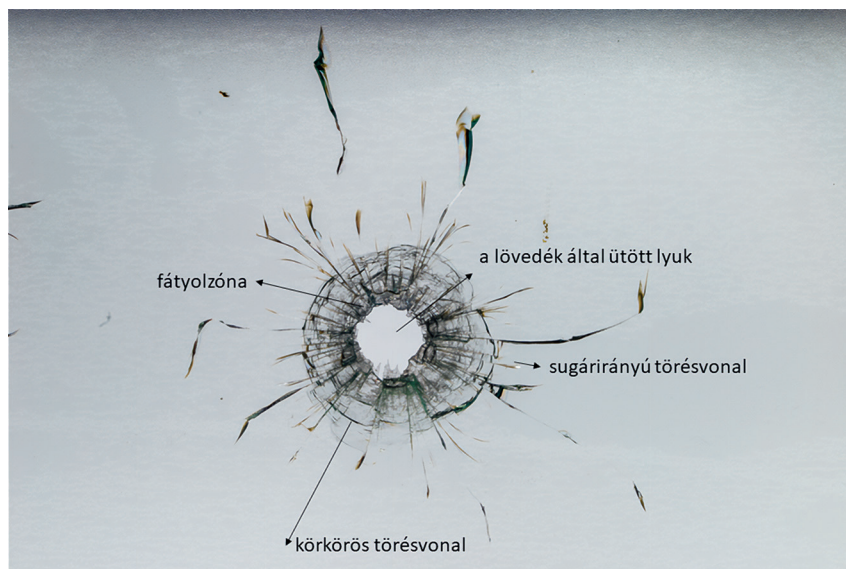
5. ábra: Lövési elváltozás egy síküveg felületén
