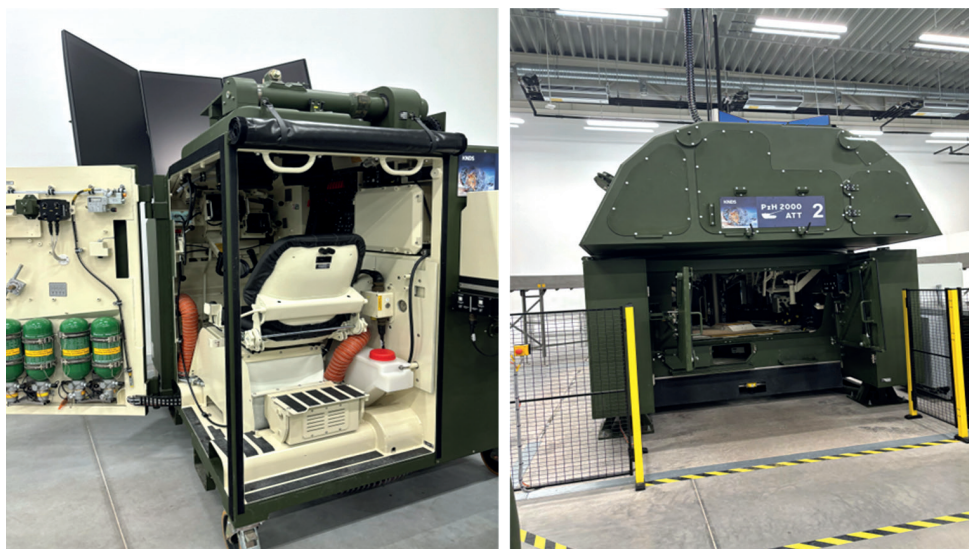
2. ábra: Tüzér szimulátor (harcjárművezető és löveg kezelőszemélyzet részére)
