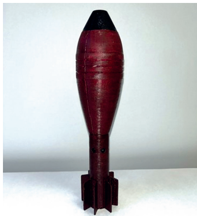
2. ábra: Polimerből 3D-nyomatással készített robbanótest makettje Forrás: a szerzők felvétele
