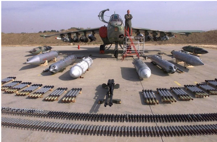
A Szu-25-ös típusú szovjet csatarepülőgép a függesztményei, fegyverzete egy részével 20
