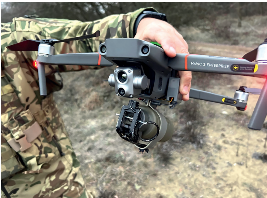
2. ábra: DJI MAVIC 2 Enterprise típusú drón dobószerszerkezettel, imitációs gránáttal szerelve Forrás: a szerző felvétele
