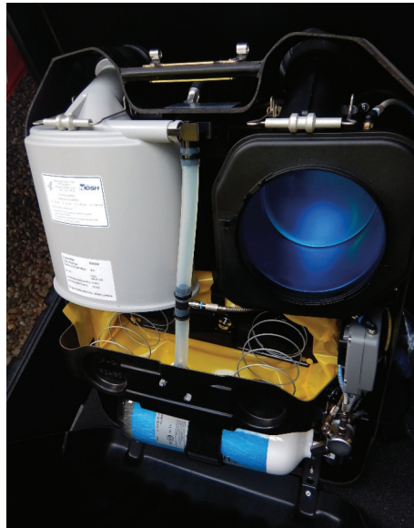
4. ábra: Egy oxigénes újralégző készülék nyitott állapotban
