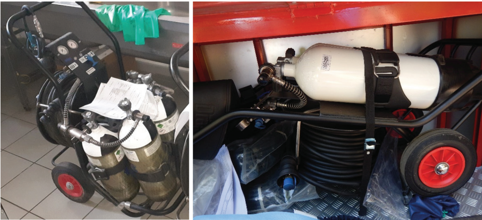
2. ábra: Mobil, többpalackos, levegőtömlős légzésvédelmi megoldások
