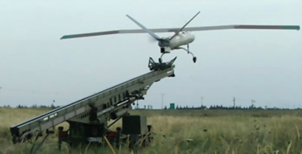
5. ábra: Hermes 450 indítása pneumatikus meghajtással
