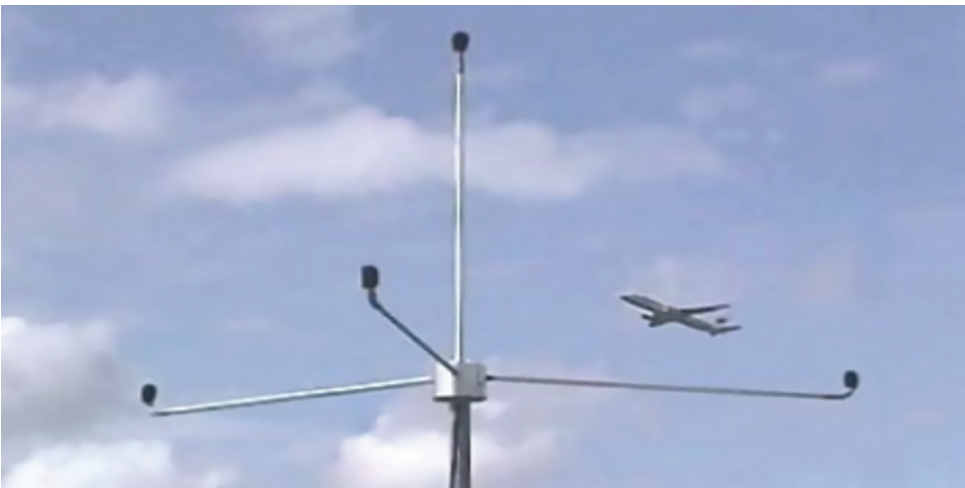
3. ábra: Repülőgép zajforrásainak monitorozása, nyomon követése Forrás: Makkay 2014a.
