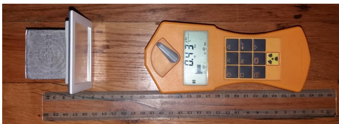
5. kép Sr-90 izotóp árnyékolása 0.25 cm-es 7367 mg/cm 3 sűrűségű ólomlemezzel 34
