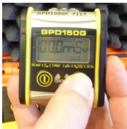
2. kép Elektronikus operatív doziméter (készítette: szerző)
