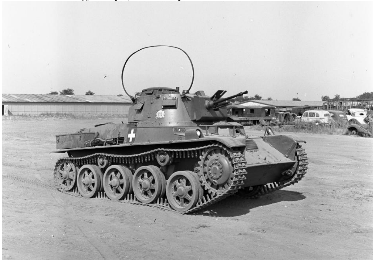
16. ábra: A sorozatgyártott és Magyar Királyi Honvédségben rendszerített 38 M. Toldi I (Toldi A20) könnyű harckocsi. [32]
