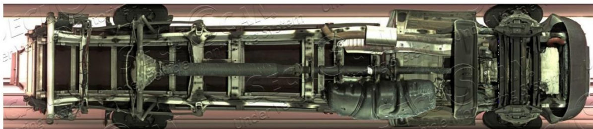
3. ábra A gépjárműalváz-vizsgáló által rögzített kép [11]
