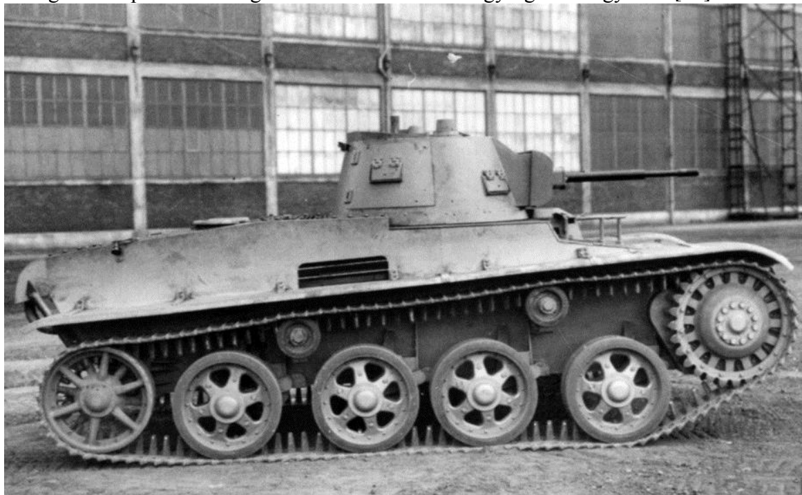
12. ábra: A Landsverk L-60 magyar próbákon is használt változata. Bár fegyverzete gyengébb volt, mint magyar riválisáé, modern, torziós rugós felfüggesztése és döntött páncélzata jóval korszerűbb konstrukciójá tette annál. [28]
