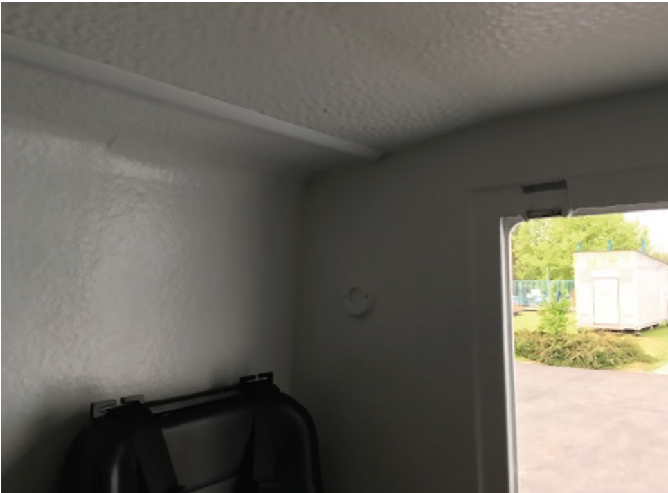
4. ábra: A jármű utasterének poliuretán bevonata, amely a dekontaminálhatóságát lehetővé teszi
