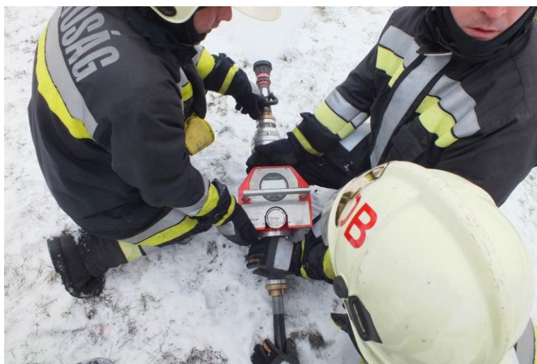
4. kép A magasnyomású gyorsbeavatkozó szállított vízmennyiségének bemérése (Himmer Krisztián, 2016)
