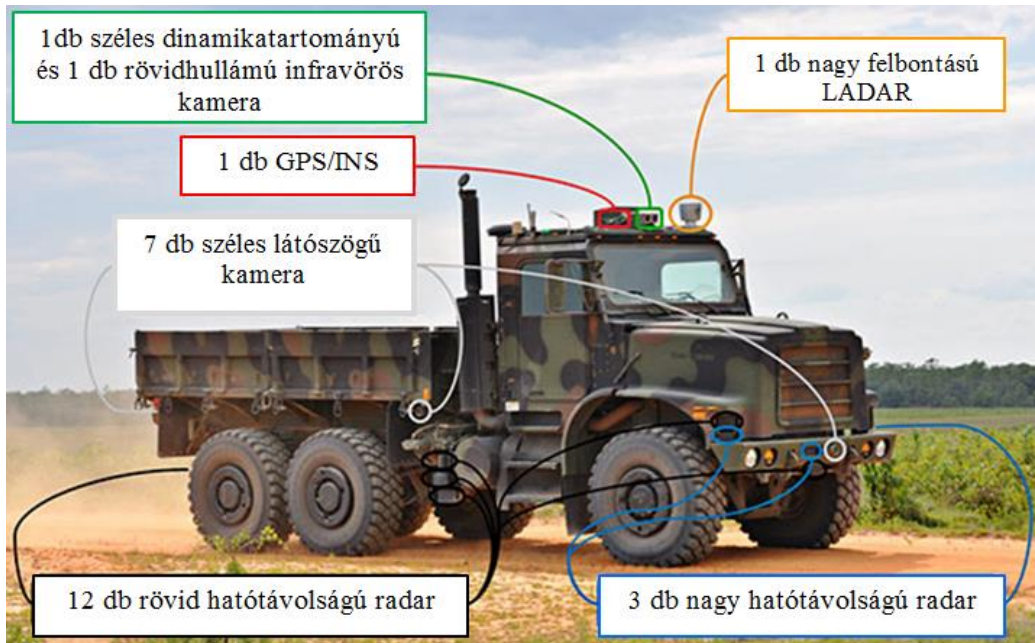
2. kép A TerraMax rendszerrel ellátott vezető nélküli szállító jármű szenzorai [11]
