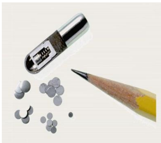
3. ábra A radiográfiai vizsgálatokhoz használatos sugárforrások leggyakrabban használt formája [4]
