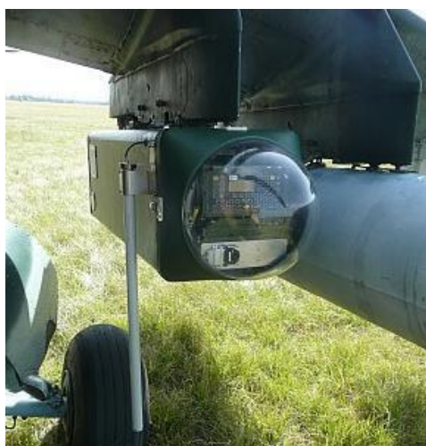
5. ábra MI-24-re függesztett ABV RIÉR konténer [12]
