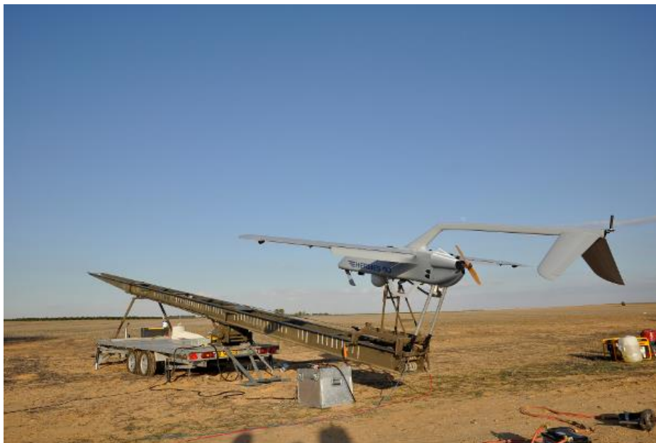
1. kép: Hermes 90 pilótánélküli légi jármű rendszer (forrás: https://www.airforce-technology.com/projects/hermes-90-tactical-unmanned-aircraft-system-uas/ )
