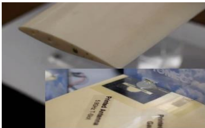
5. kép. FDM technológiával nyomtatott UAV szárny, Aerosol Jet eljárással felvitt antennával [39]
