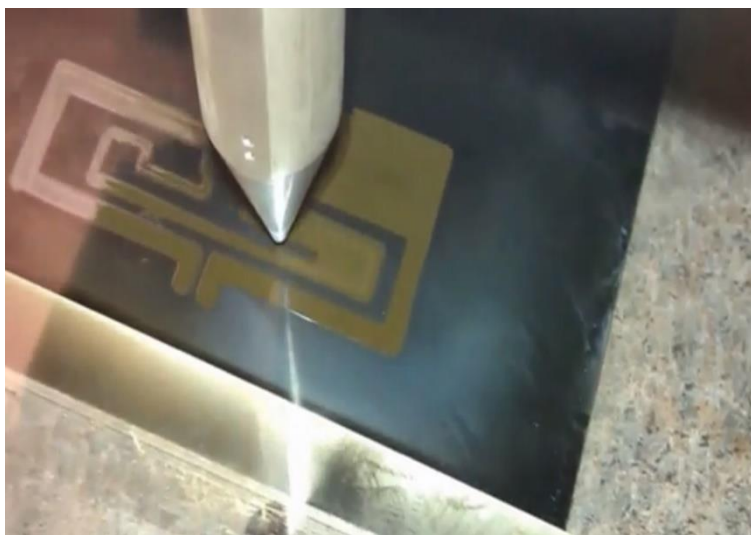
4. kép. Kétsávos antenna gyártása Aerosol Jet technológiával [32]
